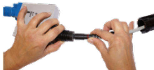
4.3 Kytke kelluvan johdon pää muuntajasta mustaan "POWER"-pistorasiaan. Kiinnitä huomiota pistotulpan suuntaan.
