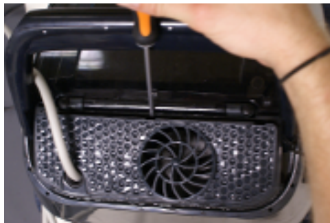
7.1. Gebruik een platte schroevendraaier om het beschermende rooster te verwijderen.
