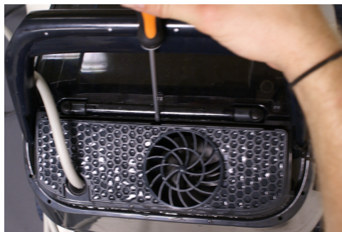
7.1. Bruk en flatskrutrekker for å fjerne beskyttelsesgitteret.
