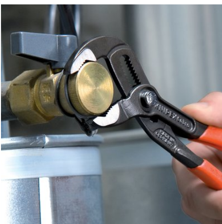
Tænder, som er forskudt mod omdrejningsretningen, giver en selvklæmende effekt og forhindrer udskridning på arbejdsområdet.
