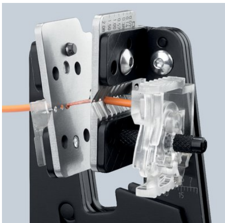
Formsluttende afisolering pga. præcise knivprofiler
