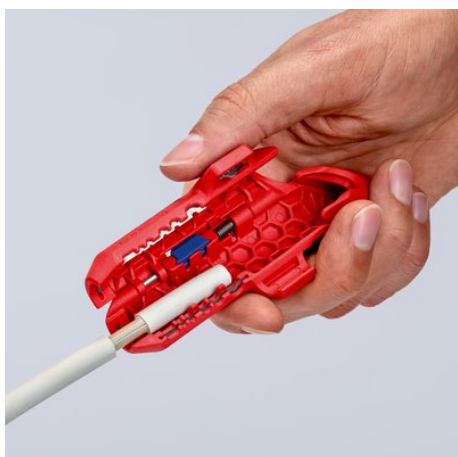
Afisolering af en NYM-kabel
